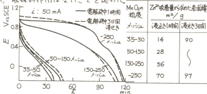
Fig. 1 酸性溶液中における放電曲線と表面積 (Table)
