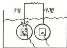
図4. n-p-GaP電極を用いる電気化学光電池
