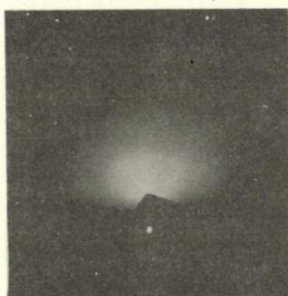
図6.  $\text{Si}$ 膜の電子回折結果
