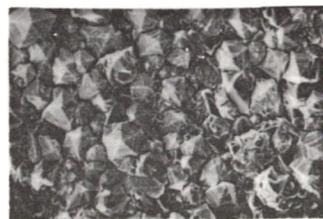
写真 Watts浴, 40°C,  $0.7\ \text{V vs Ag/AgCl}$
