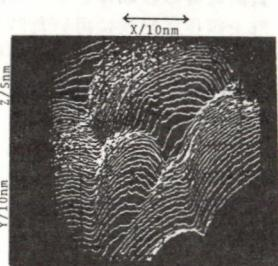
図1 ナフィオン上に真空蒸着した金のSTM像
