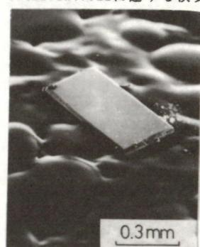
$\text{SrCl}_2 \cdot \text{BaCl}_2 \cdot \text{NaCl}$ 系混合フラックスにより得られたSBN単結晶
