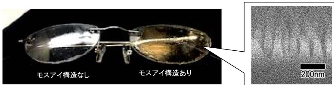
図2 ポラスアルミナを用いた光インプリントにより反射防止構造を形成した眼鏡レンズ
